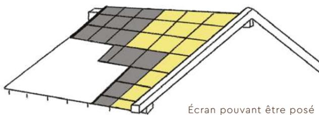
Écran pouvant être posé directement sur l'isolant
